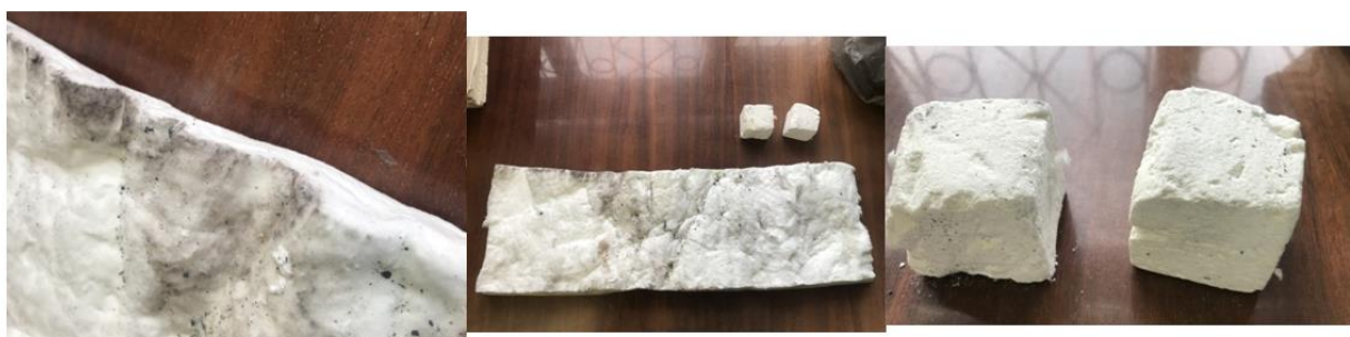
Рисунок 3.7 – Материал после цикла нагрева в нагревательной печи
