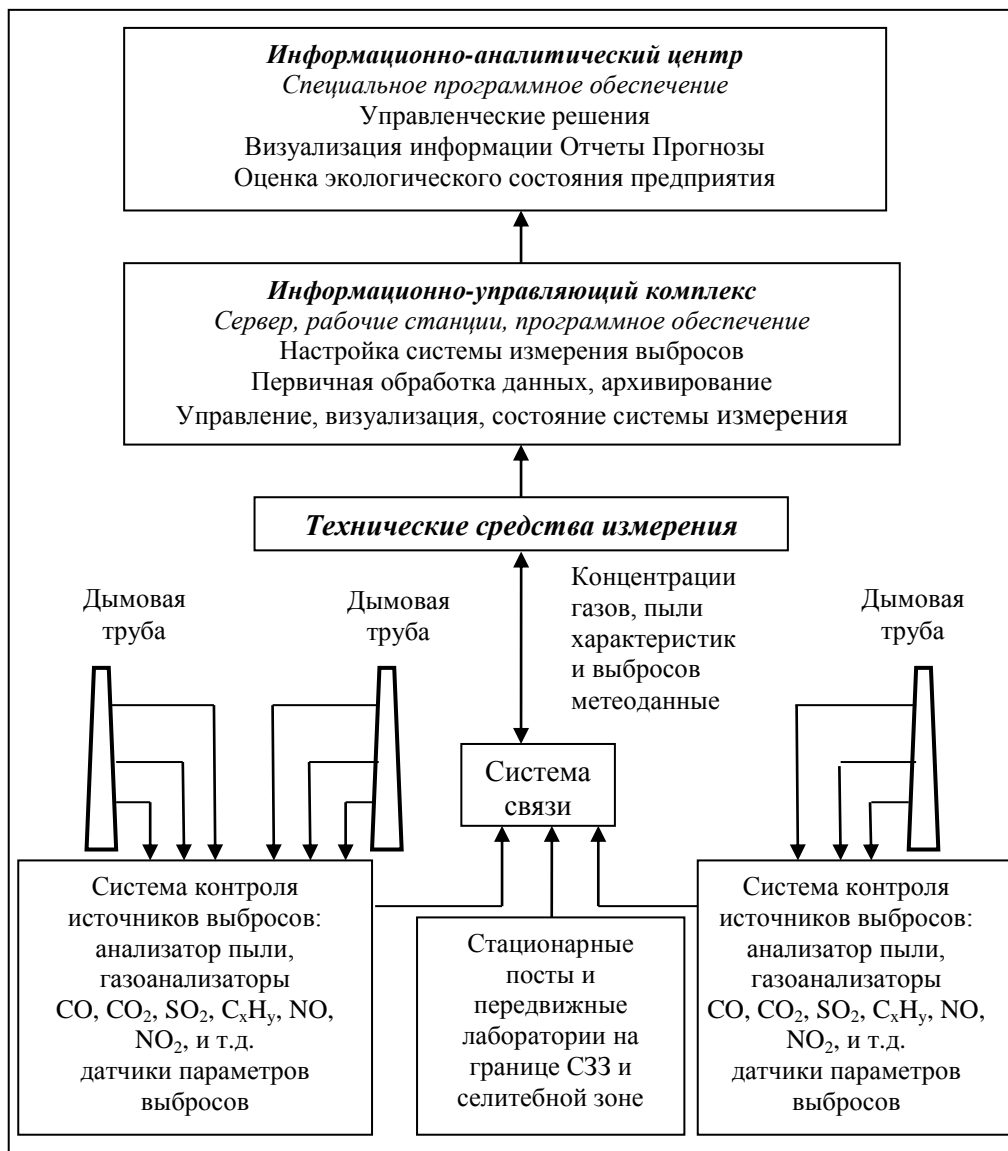
Рисунок 2.1 – Принципиальная схема АС ПЭМ промышленных выбросов
