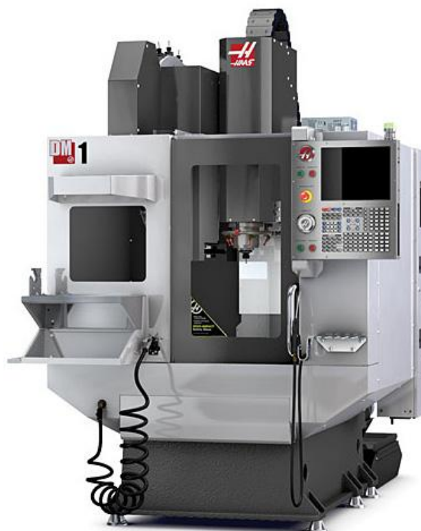
Рис. 2.3. Вертикально-фрезерный 4-х осевой обрабатывающий центр HAAS DM-1 с ЧПУ.
