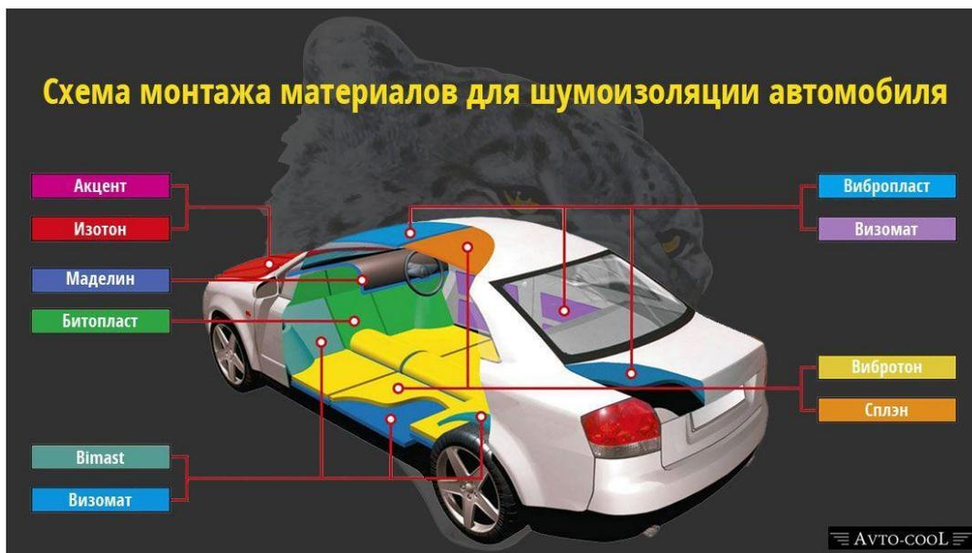
Рисунок 12 - Монтаж шумоизоляционных материалов
