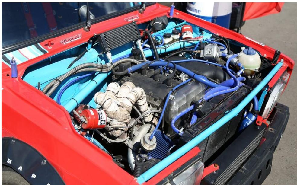
Рисунок 9 – Тюнинг двигателя «ВАЗ 2107»
