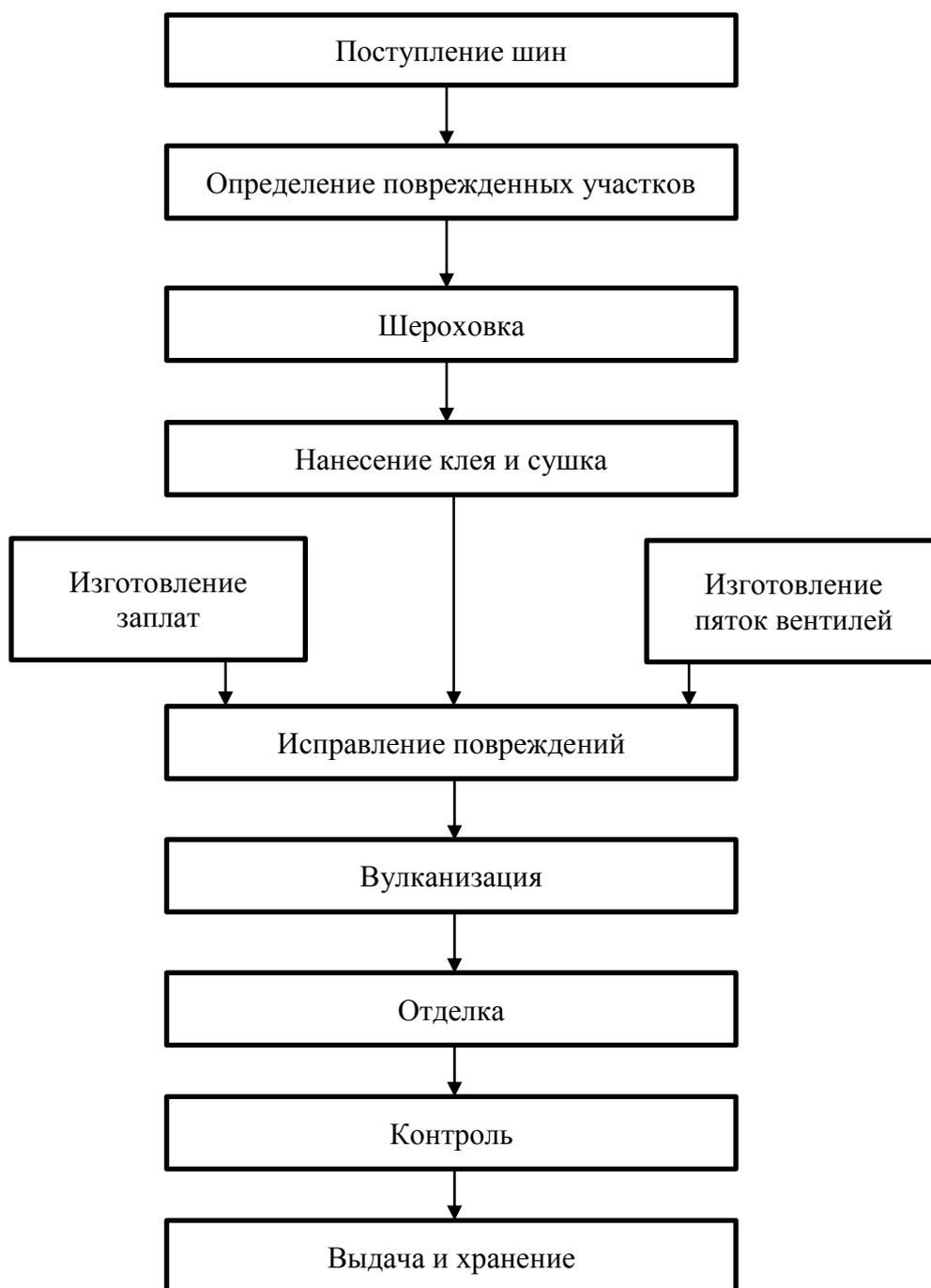
Рисунок 5.2 - Последовательность выполнения операций по ремонту шин
