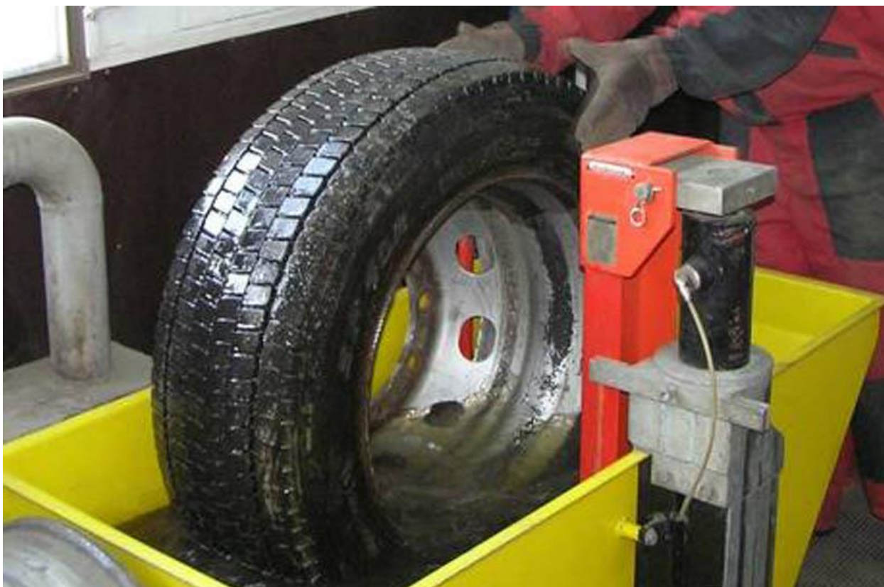
Рисунок 2 – Установка для проверки колес на герметичность с пневматическим цилиндром:
