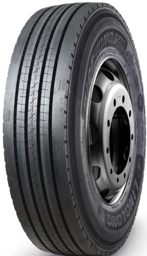
Рисунок 10 – Магистральная грузовая шина
