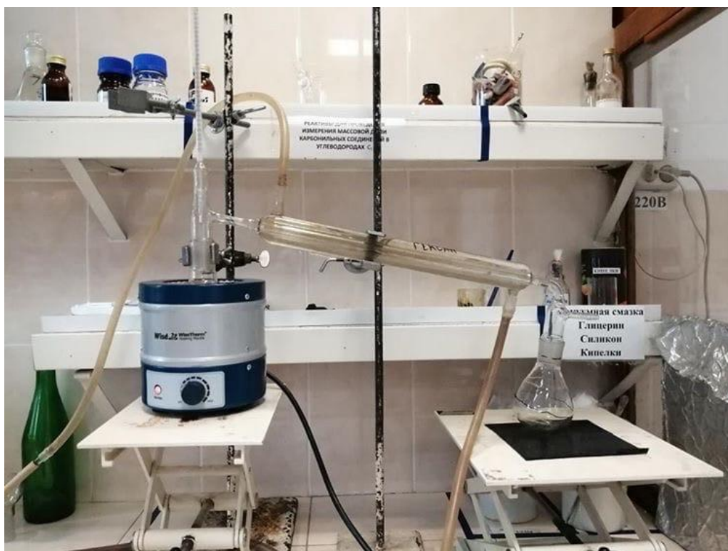
Рисунок 22 – установка перегонки гексана
