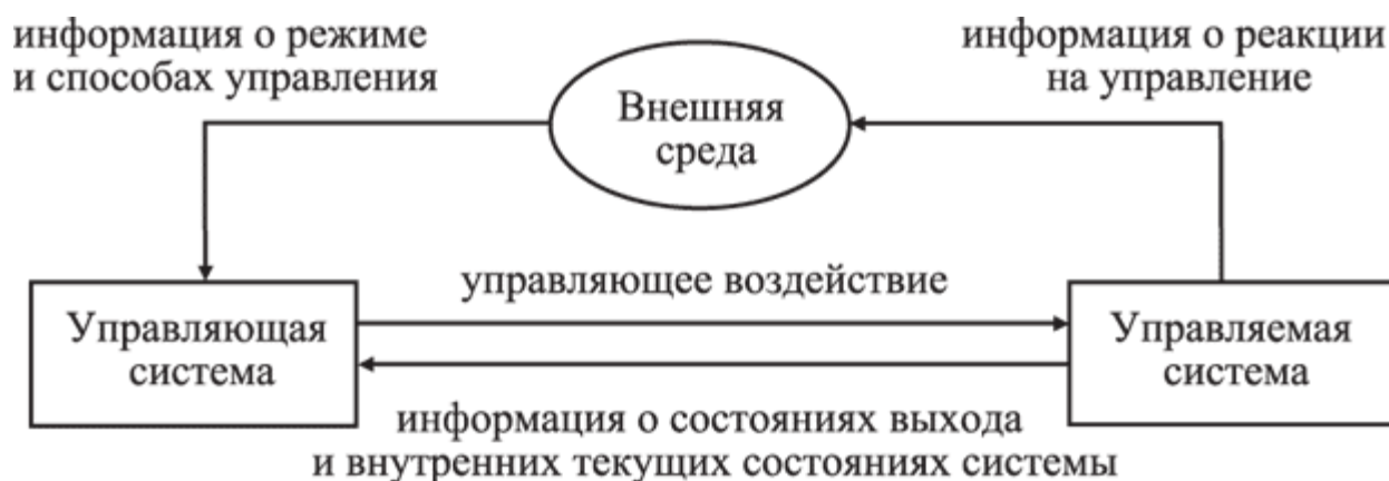
Рисунок 7 - Общая схема управления системой
