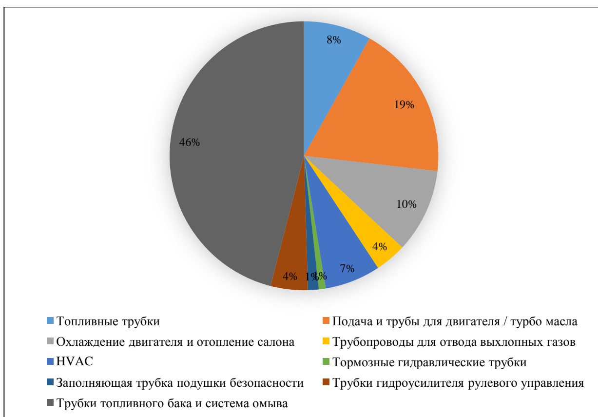
Рисунок 6 – Дефекты в цехе по производству систем передачи жидкости
