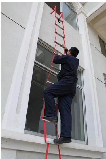
Рисунок 3 - Спуск из окна второго этажа при помощи навесной спасательной лестницы
