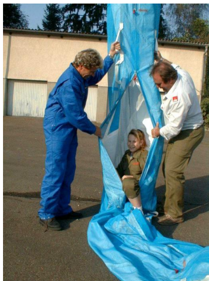
Рисунок 1 - Спуск человека в эластичном рукаве
