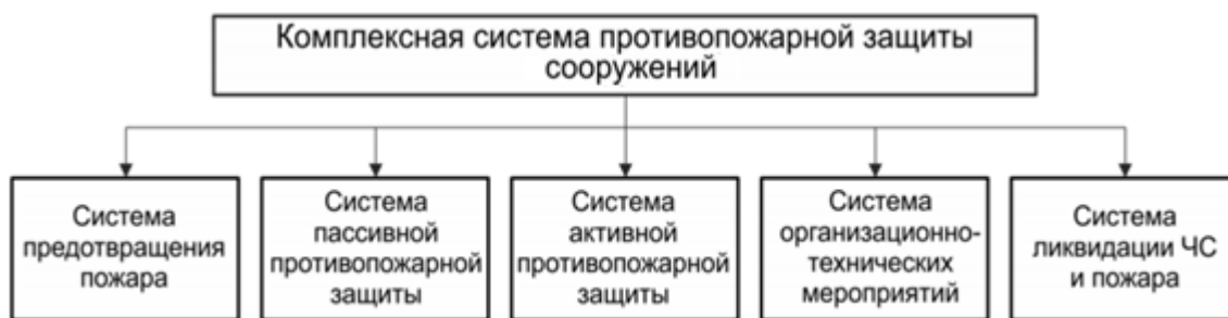
Рисунок 2.3 - Комплексная система противопожарной защиты
