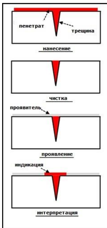
Рисунок 2.6 – Принцип капиллярного метода контроля [18]
