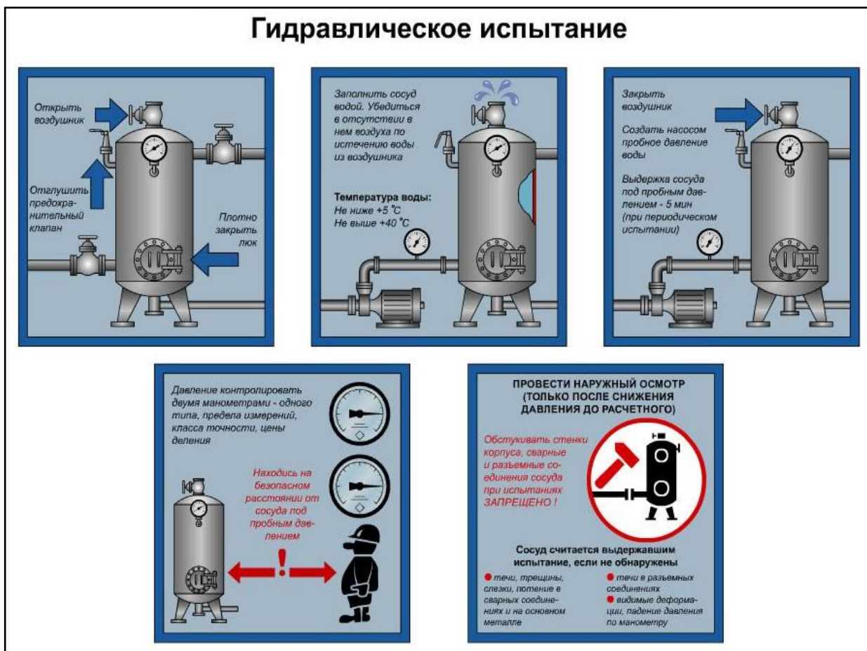
Рисунок 2.9 – Порядок проведения гидравлического испытания [17]
