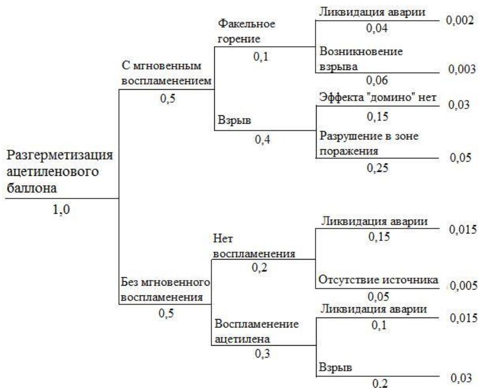
Рисунок 9 – «Дерево событий» при разгерметизации ацетиленового баллона
