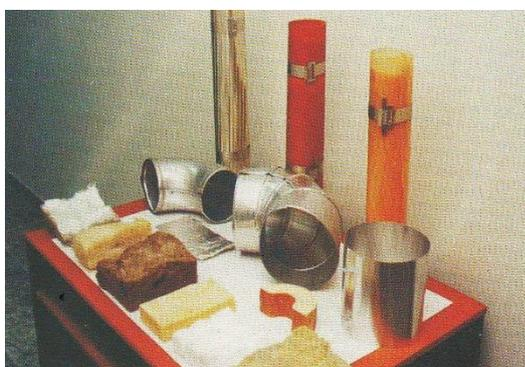
Рисунок 10 – Изделия и материалы, используемые для тепловой изоляции
