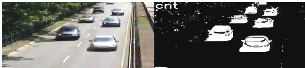
Рисунок 2.11 – Исходный кадр (слева) и маска заднего фона полученная субтрактором CNT
