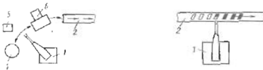
1 – промышленный робот; 2 – конвейер; 3 – основное технологическое оборудование; 4, 5 и 6 – магазины с заготовками
