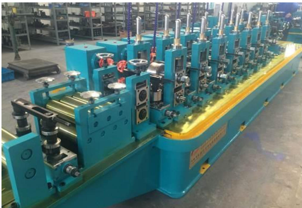
Рисунок 3.6 - Прокатный стан для формирования круглой трубы
