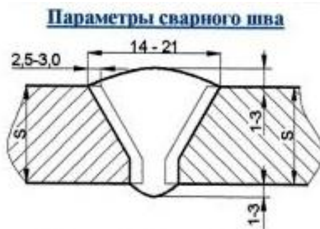
Рисунок 1.3 – Параметры сварного шва
