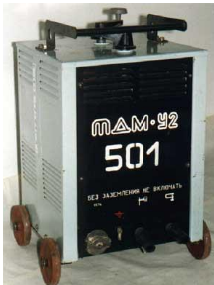
Рисунок 2.7 – Сварочный трансформатор ТДМ-501
