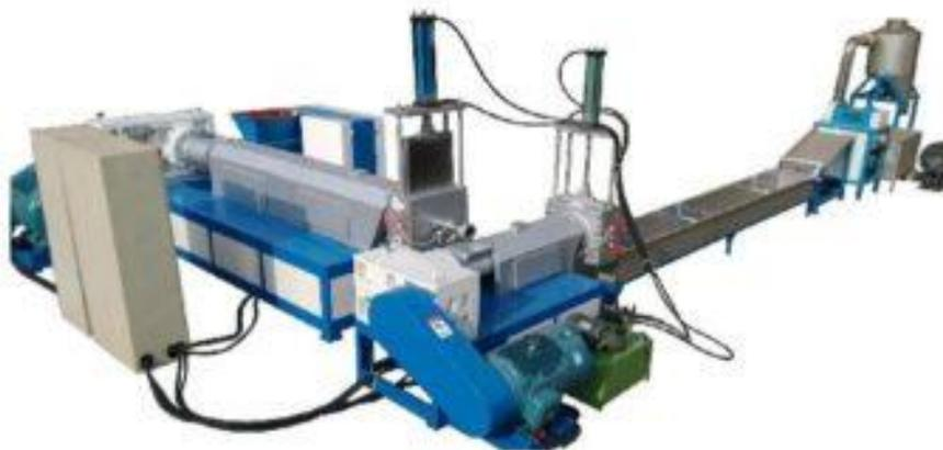
Рисунок 5 – Двухкаскадный шнековый экструдер
