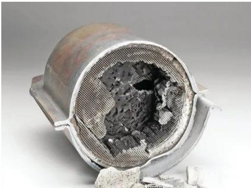
Рисунок 2 - Катализатор, пораженный каталитическими ядами
