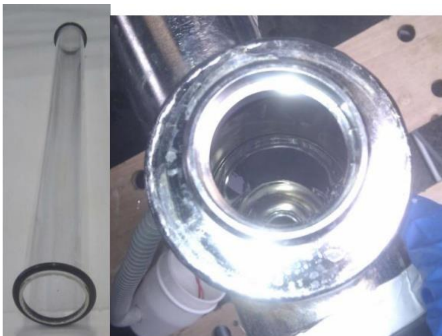
Рисунок 17 – После 24 часов: полностью очищенное стекло и УФ реактор.
