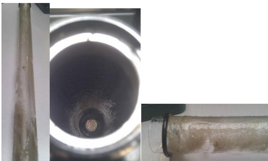
Рисунок 15 – Биообрастание кварцевых защитных стёкол
