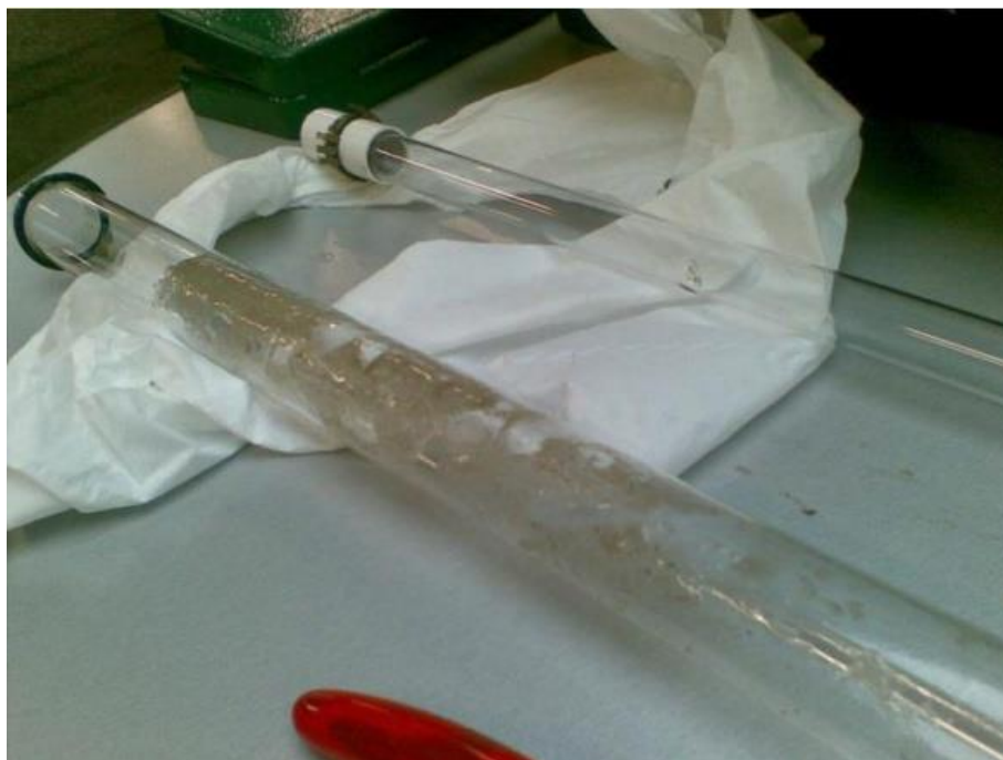
Рисунок 16 – После 3 часов обработки ультразвуком: сокращение биоплёнки
