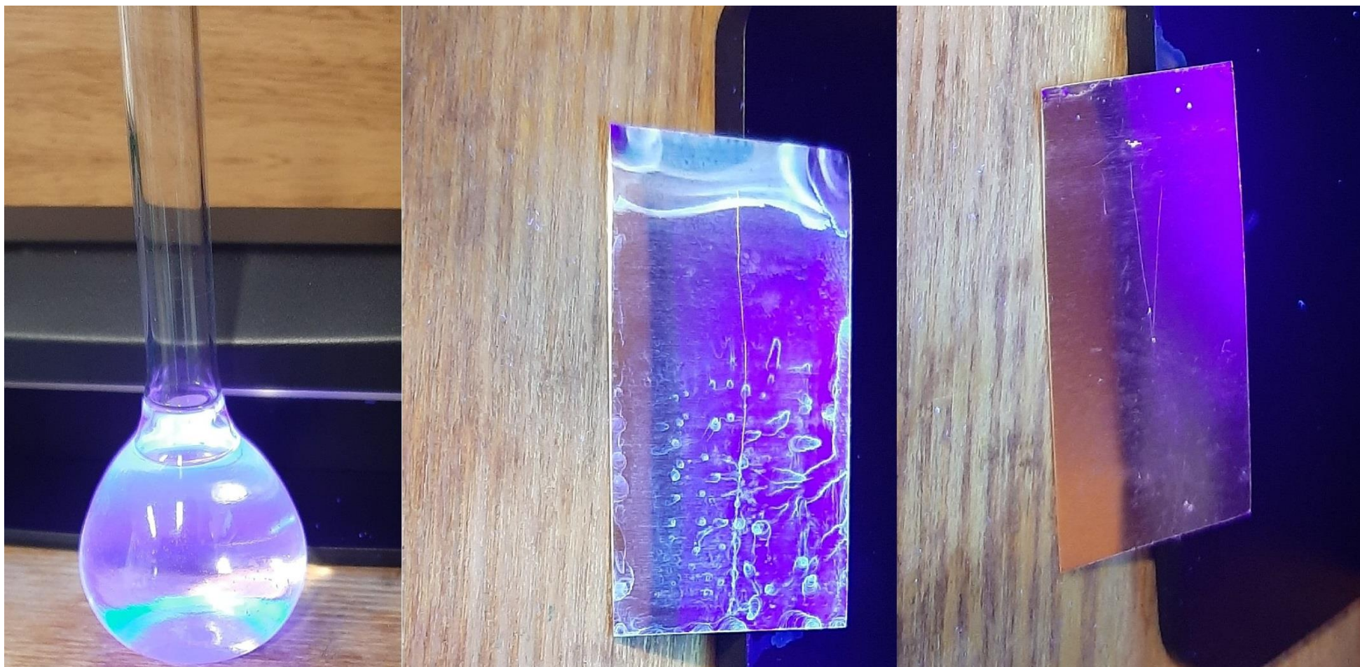
Рисунок 55 – Испытание (E)-5-(2-(Бензофуран-2-ил)винил)-1,3-дифенил-1H-пиразол 103j во флуоресцентной дефектоскопии
