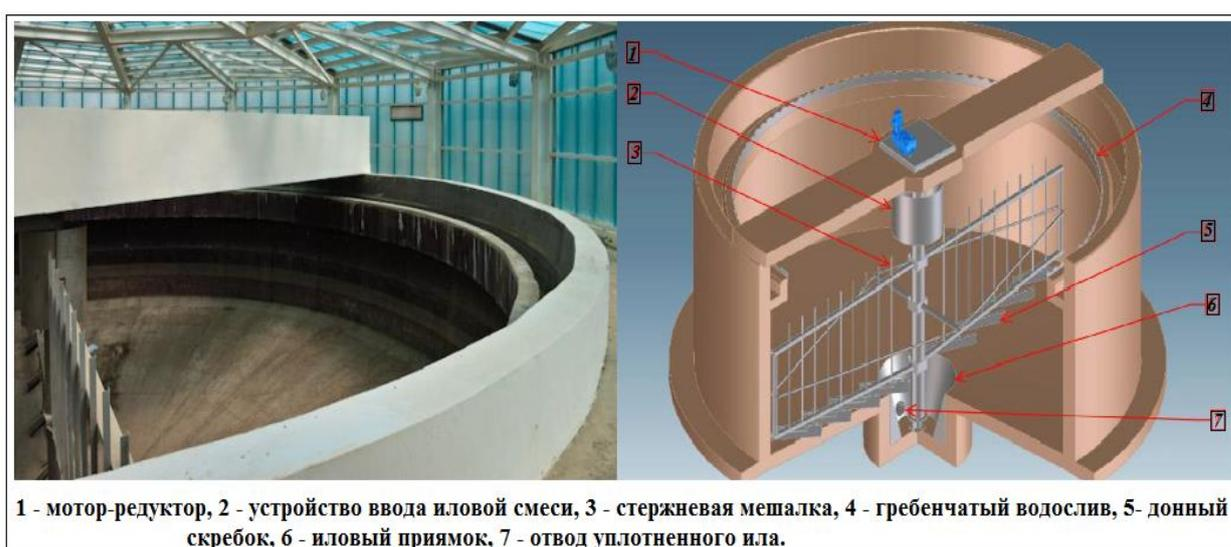
Рисунок 6 - Общий вид запланированного илоуплотнителя [23]
