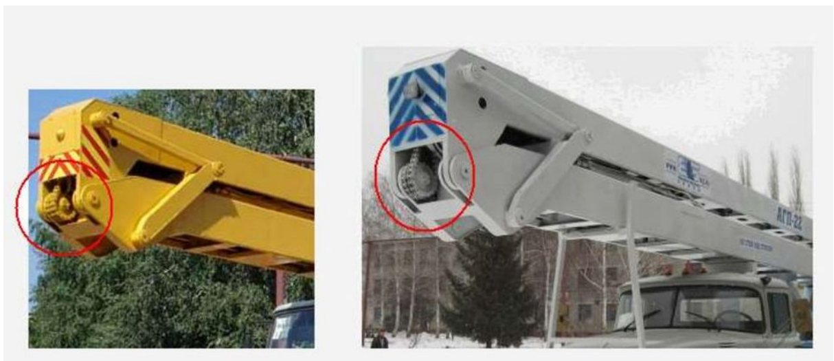
Рисунок 5 – Элементы системы стабилизации люльки АГП цепного типа
