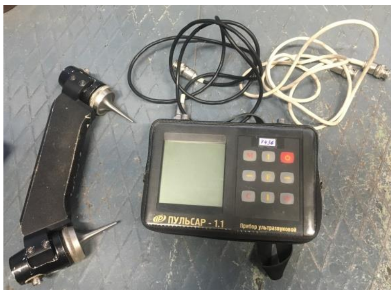
Рисунок 2.4 – Прибор неразрушающего контроля прочности бетона: ультразвуковой прибор «Пульсар»
