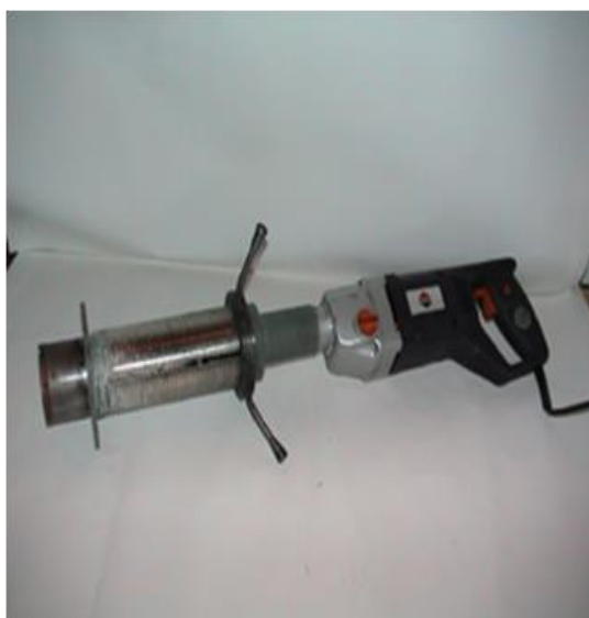
Рисунок 2.6 – Прибор механического (эталонного) метода определения прочности бетона: установка для выбуривания образцов – кернов из конструкции
