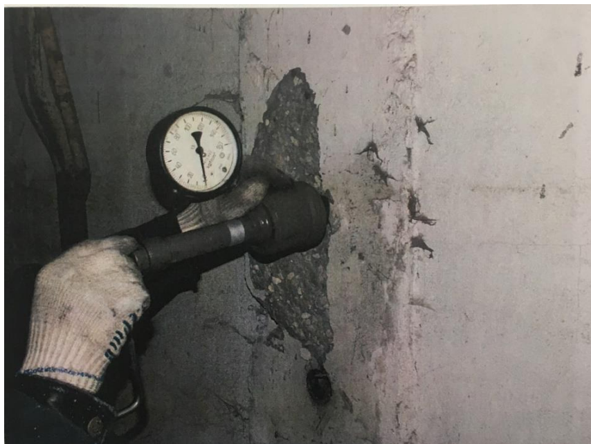
Рисунок 3.3 – Проведение испытаний прямым методом отрыва со скалыванием с помощью прибора ПБЛР
