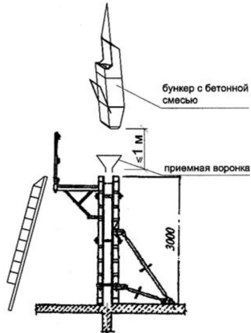
Рисунок В.7 – Схема бетонирования стен
