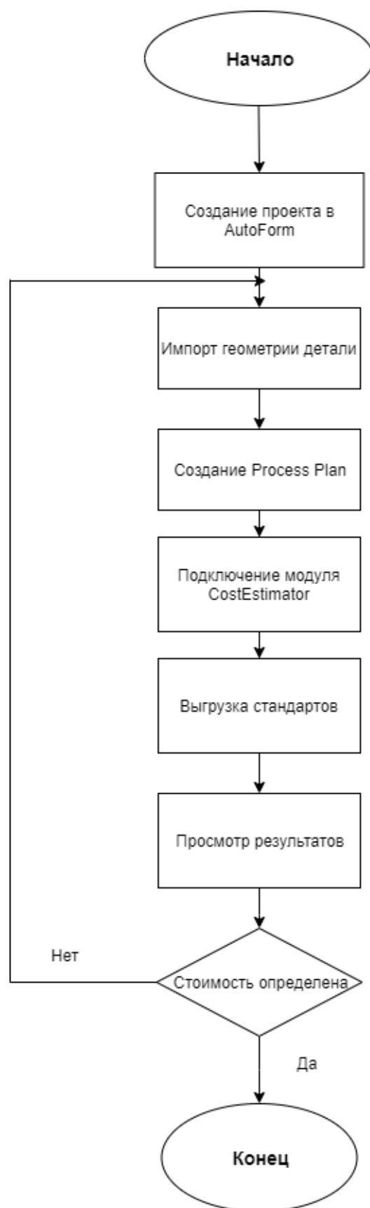
Рисунок 36 – Алгоритм определения стоимости штамповой оснастки
