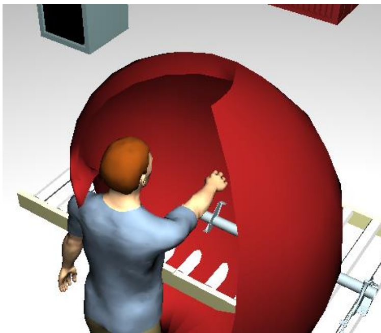
Рисунок 3.14 – Визуализация работы инструмента «Анализ досягаемости цифровым манекеном»
