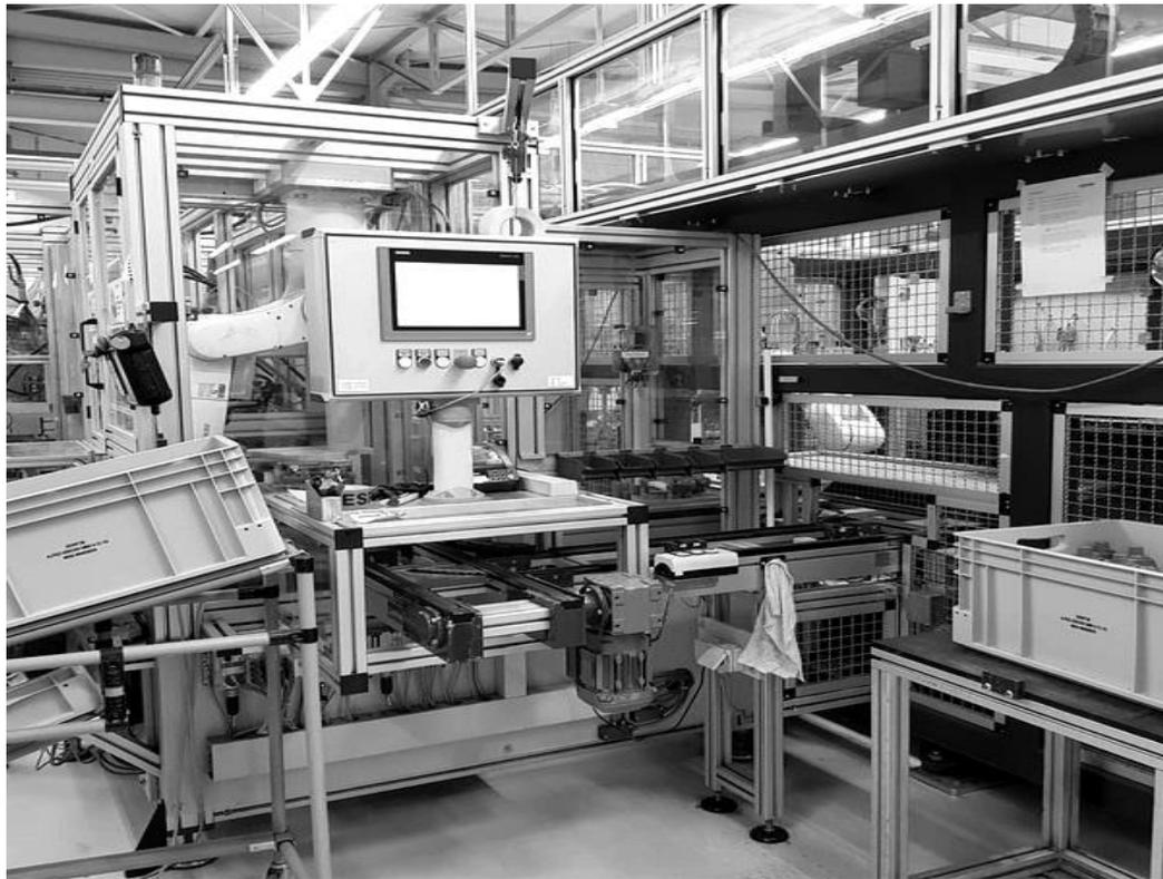
Рисунок 11 – Рабочее место оператора сборки диска сцепления
