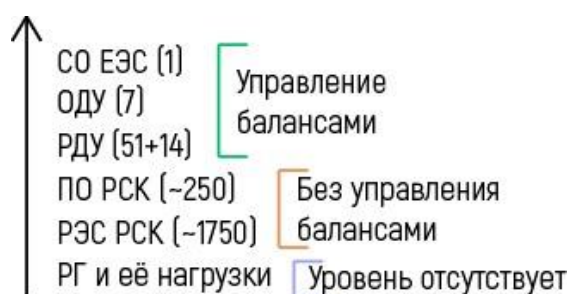
Рисунок 13 – Уровни управления объектами электроэнергетики и формирование балансов мощности и энергии
