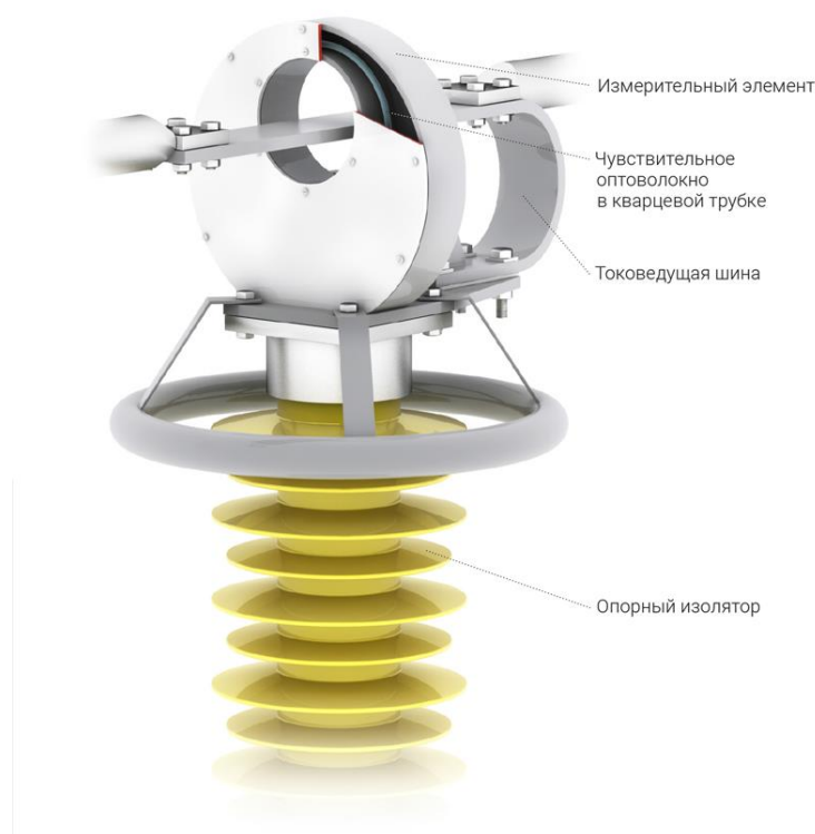
Рисунок 4 – Трансформатор тока электронный оптический
