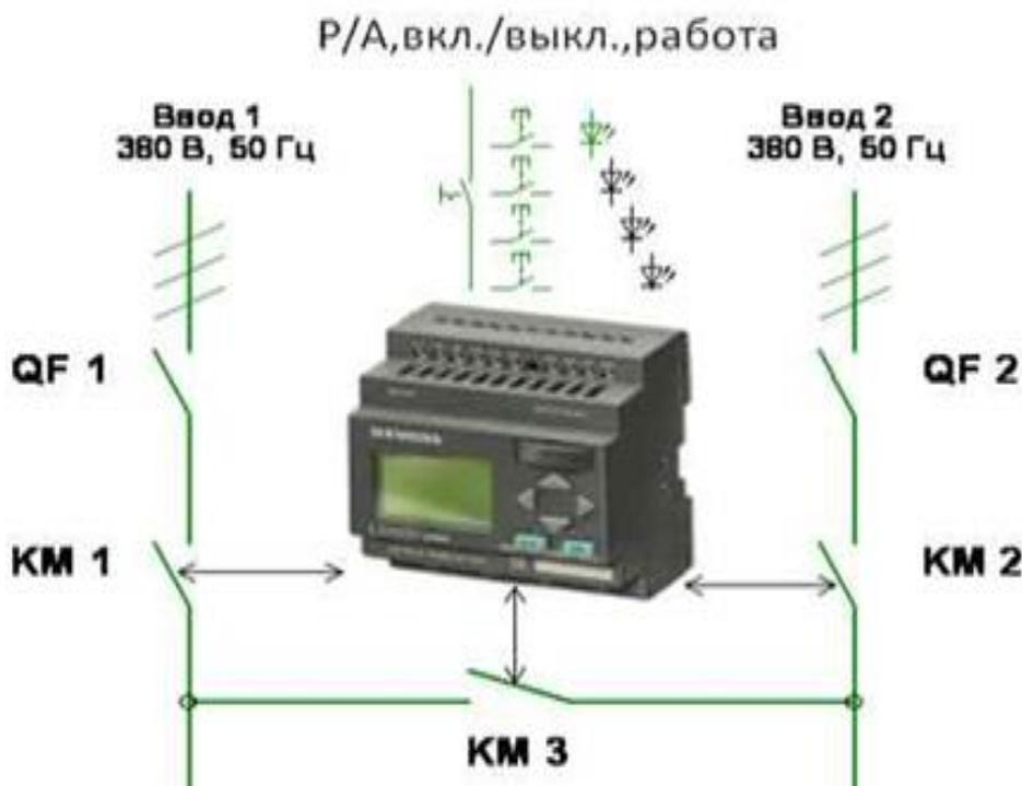
Рисунок 28 – Схема АВР на контроллере ф. Siemens серии LOGO
