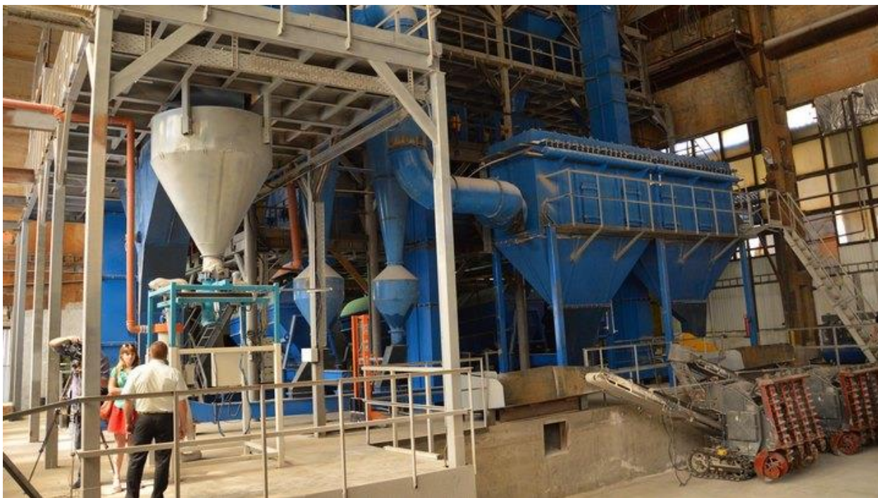
Рисунок 3 – Установка по производству сульфата аммония
