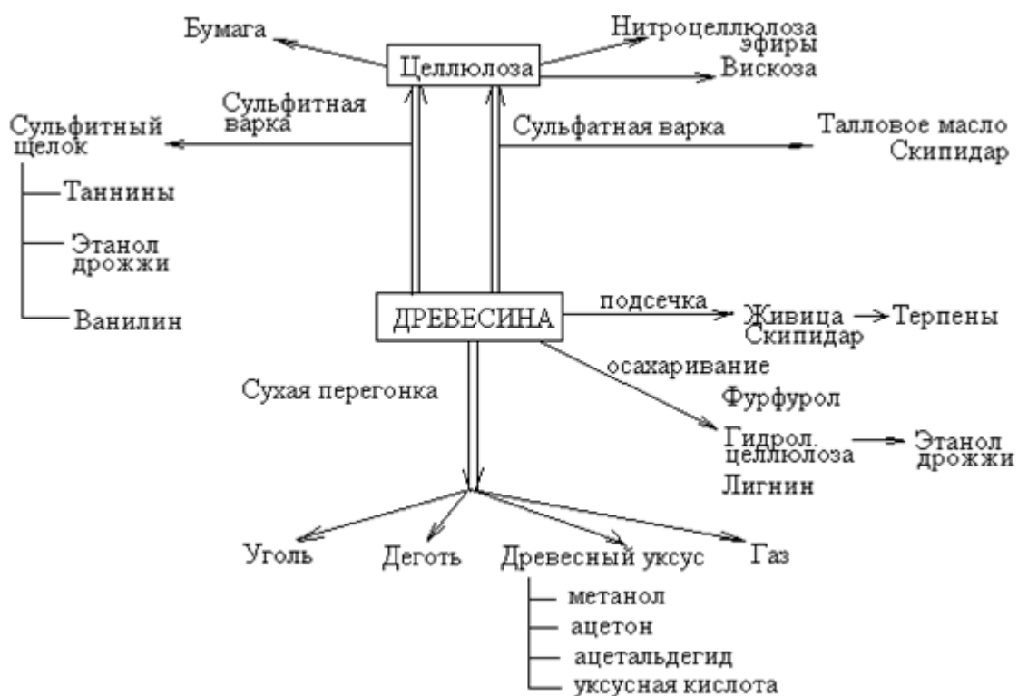
Рисунок 2 - Общая схема химической переработки древесины в целлюлозно-бумажном производстве [18]
