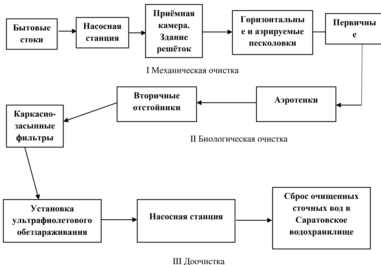
Рисунок 2 – Технологическая схема очистки сточных вод на предприятии «Автоград – Водоканал»
