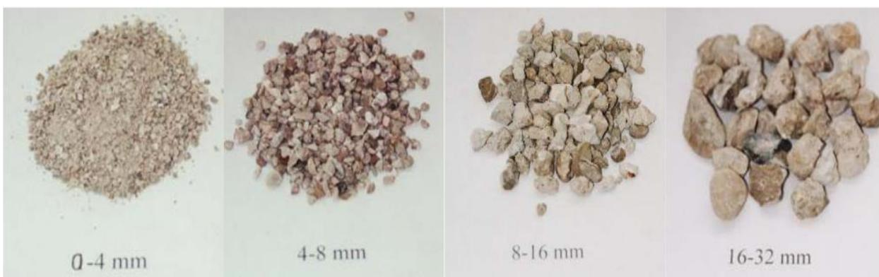
Рисунок 10 - Форма и текстура поверхности различных фракций переработанного заполнителя
