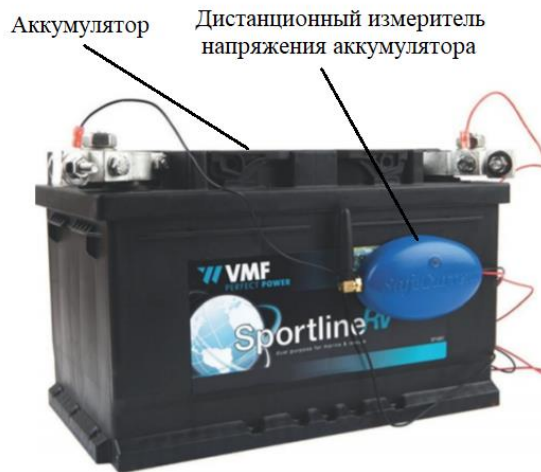
Рисунок 3 – Устройство SafeCurrent Battery Monitor для дистанционного мониторинга напряжения аккумулятора.
