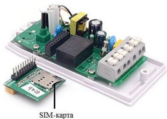
Рисунок 7 – Разъем для SIM-карты в GSM-реле Sonoff G1.
