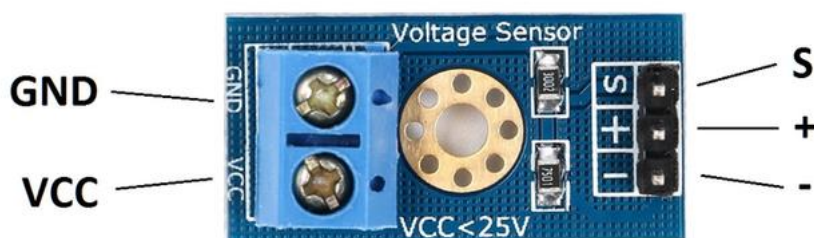
Рисунок 29 – Датчик постоянного напряжения на основе резистивного делителя напряжения.
