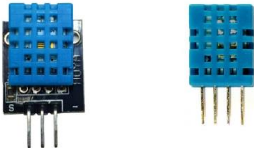
Рисунок 5.9 – Слева Датчик влажности воздуха и температуры, справа Датчик DHT11 который крепится на печатную плату
