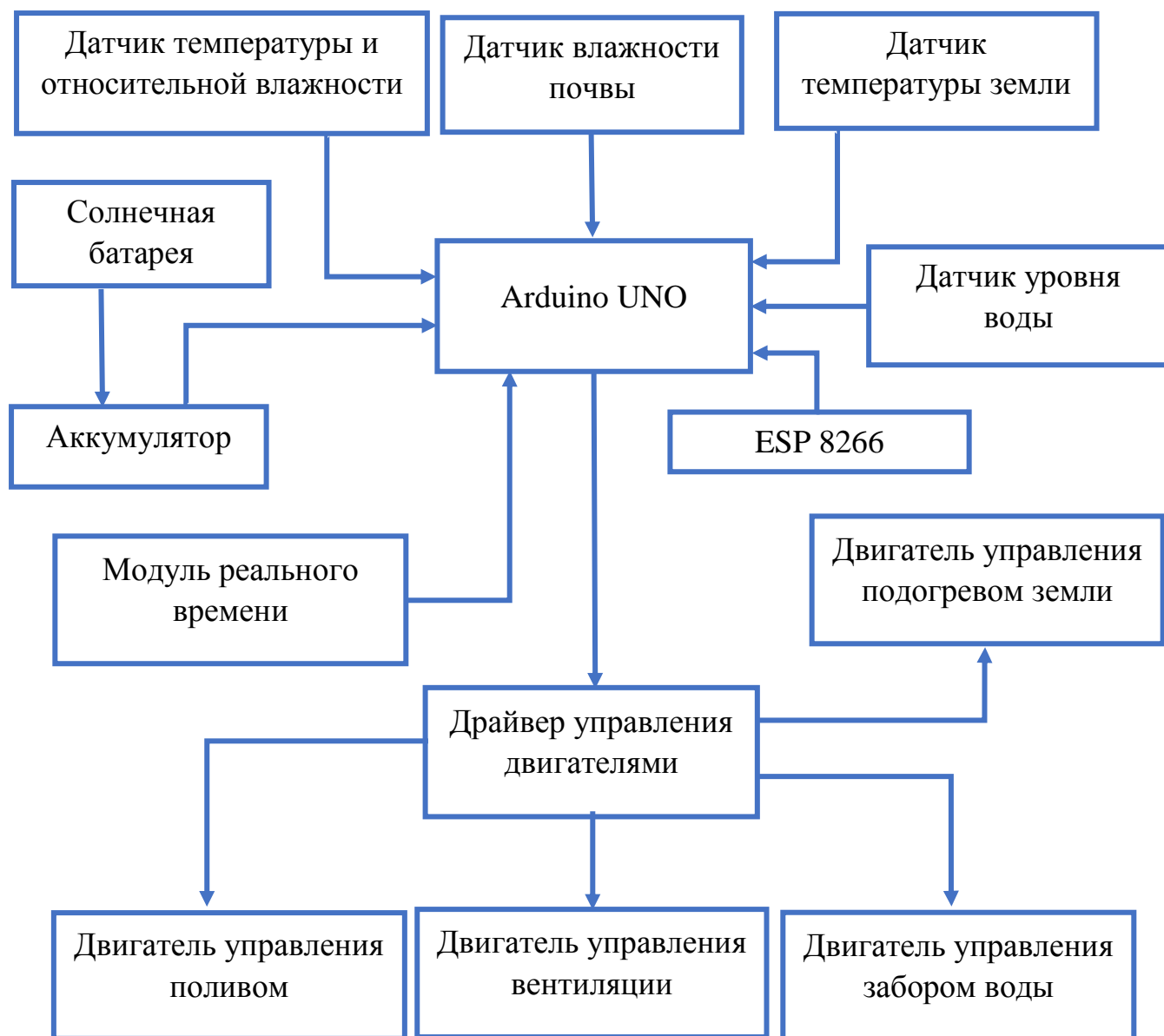
Рисунок 4.1 – Структурная схема системы автоматического орошения
