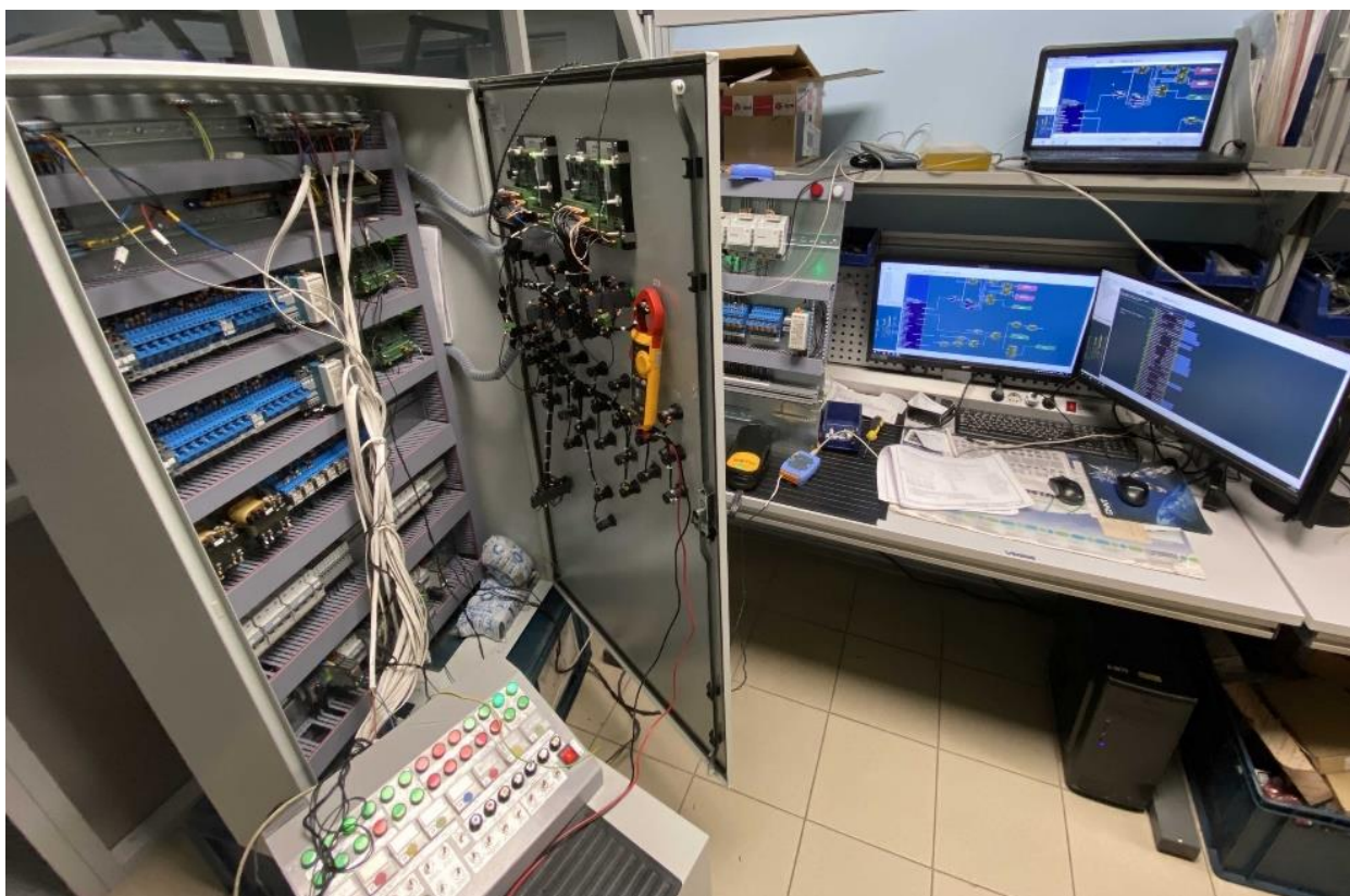
Рисунок 43 – Старый стенд с подключенным на проверку ШУ
