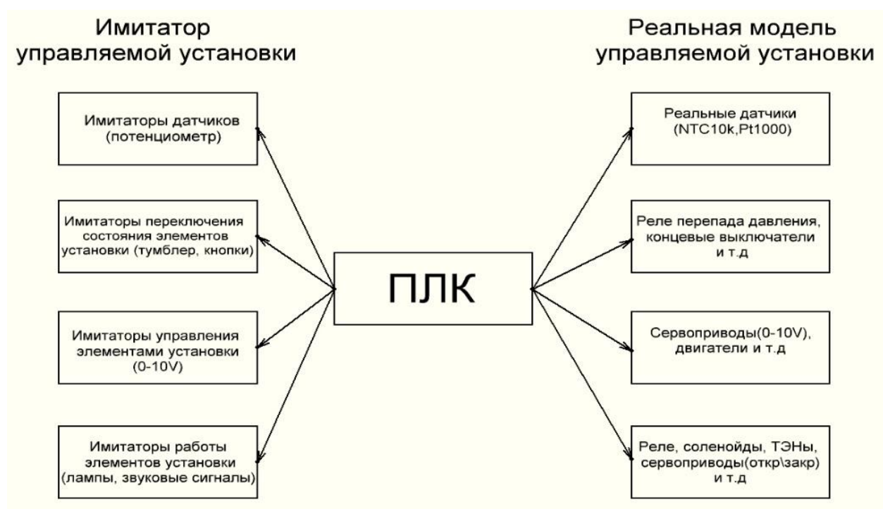
Рисунок 4 — структурная схема имитационного стенда
