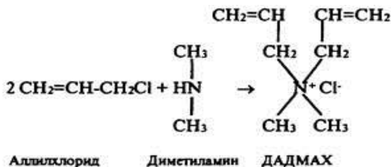
Рисунок 6 – Получение мономера ДАДМАХ
