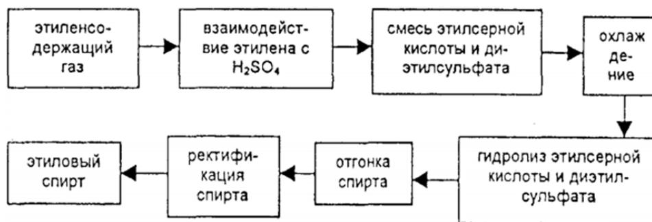
Рисунок 4 – Способ получения этанола сернокислотной гидратацией
