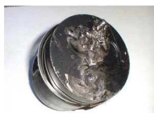
Поверхность поршня до восстановления
