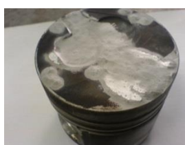
Наплавка рабочей поверхности поршня
