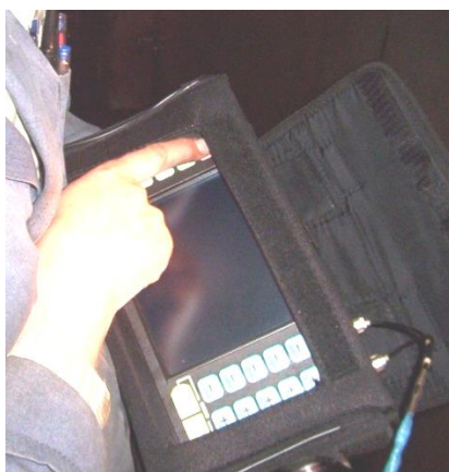
Рисунок 1.6 – Ультразвуковой дефектоскоп УД2-102
