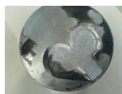
Фрезерование рабочей поверхности поршня
