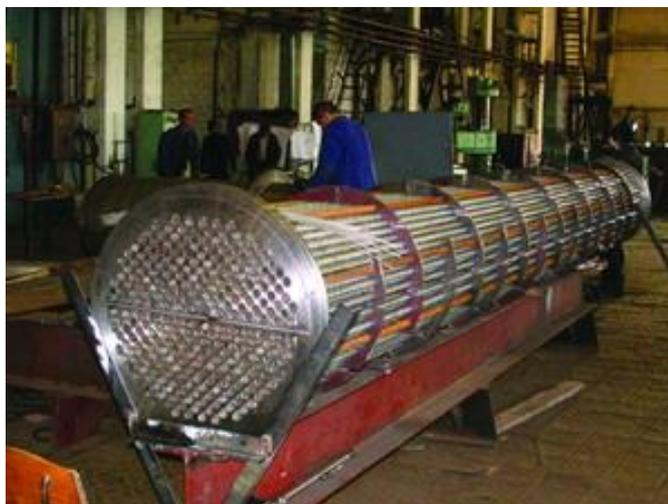
Рисунок 2.9 – Сборка труб и трубных досок
