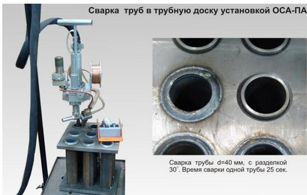
Рисунок 2.10 – Сварка труб на установке ОСА-ПА
