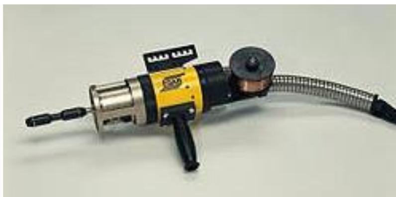
Рисунок 2.2 – Сварочная головка РОС 12-60 для сварки труб в трубную доску
