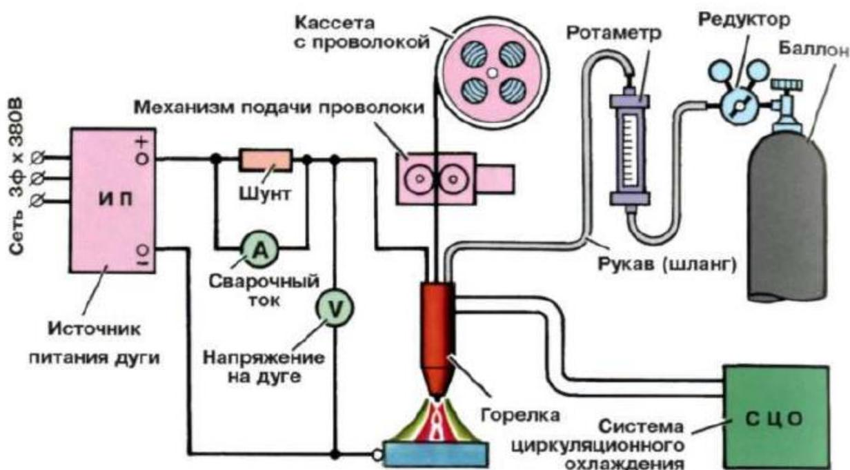
Рисунок 2.4 – Сварка плавящимся электродом в защитных газах
