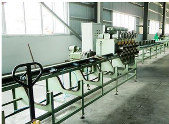
Рисунок 2.5 – Правка сортового проката на машине JZJ20-40
