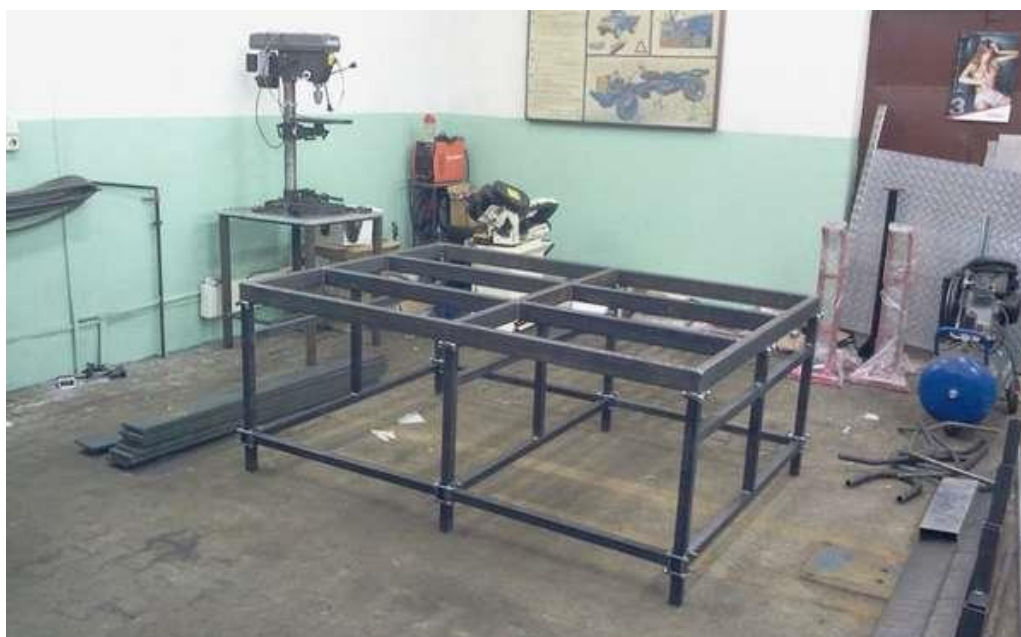
Рисунок 2.8 – Стенд для сборки и сварки
