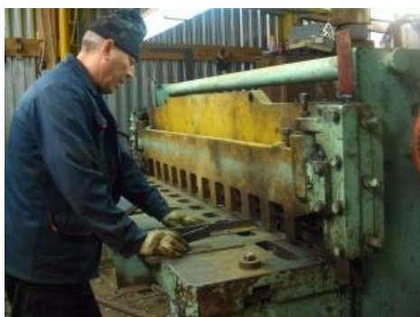
Рисунок 1.3 – Резка листовых заготовок на ножницах НД3312Б
