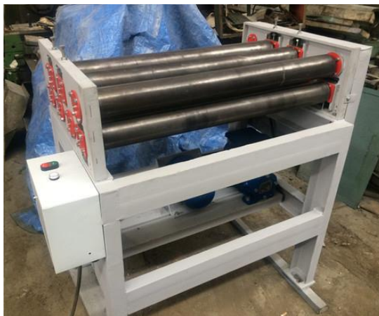
Рисунок 2.4 – Правка листового проката на многовалковой машине ЛВ-7-1000
