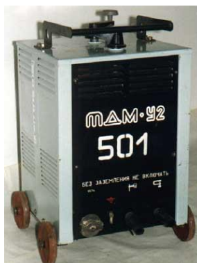
Рисунок 2.7 – Сварочный трансформатор ТДМ-501
