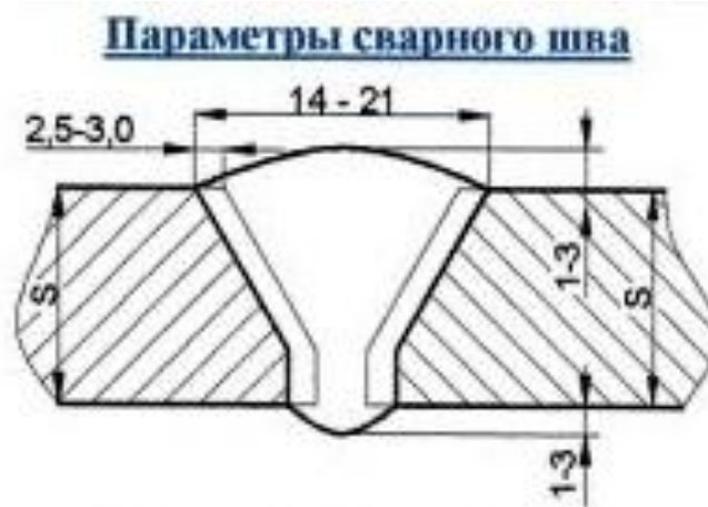
Рисунок 1.3 – Параметры сварного шва
