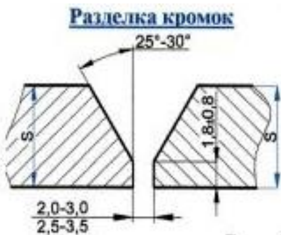
Рисунок 1.2 – Разделка кромок
