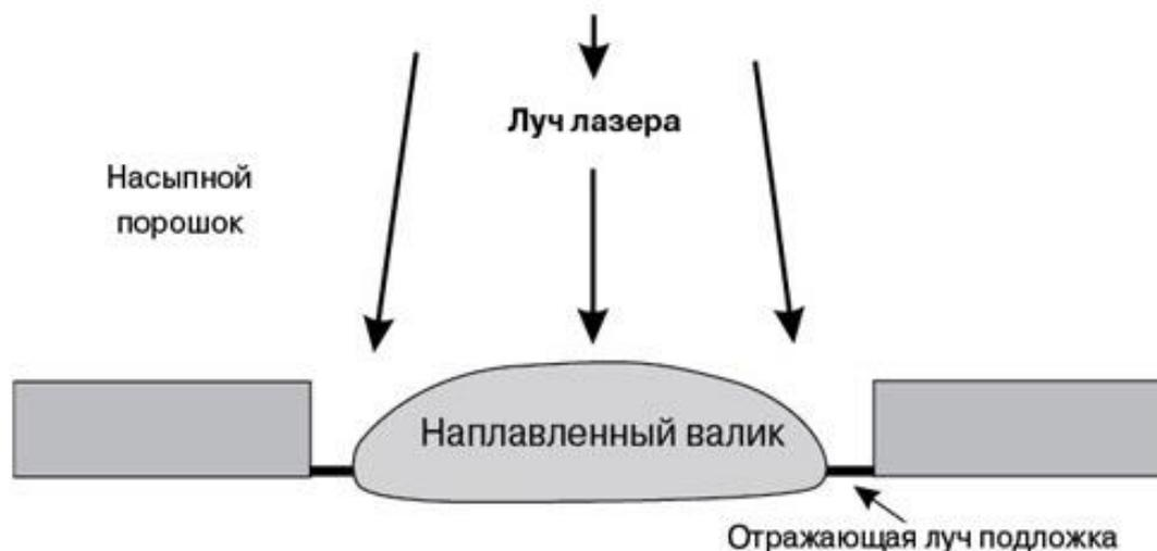
Рисунок 2.4 – Схема восстановительной лазерной наплавки с предварительным нанесением порошка
