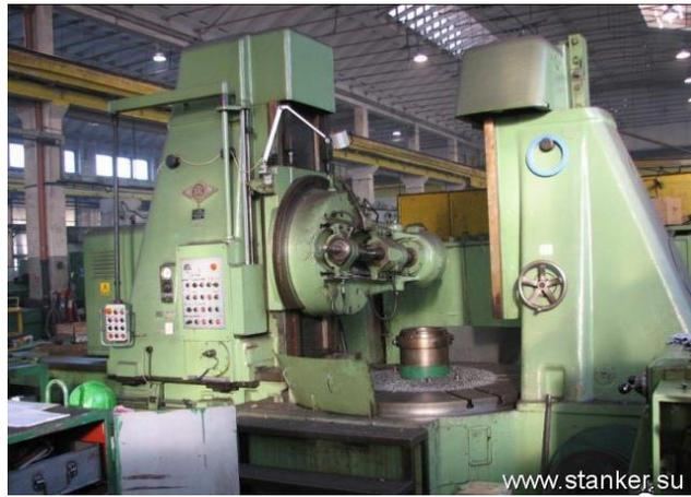
Рисунок 1.6 – Общий вид зубофрезерного станка 5А342
