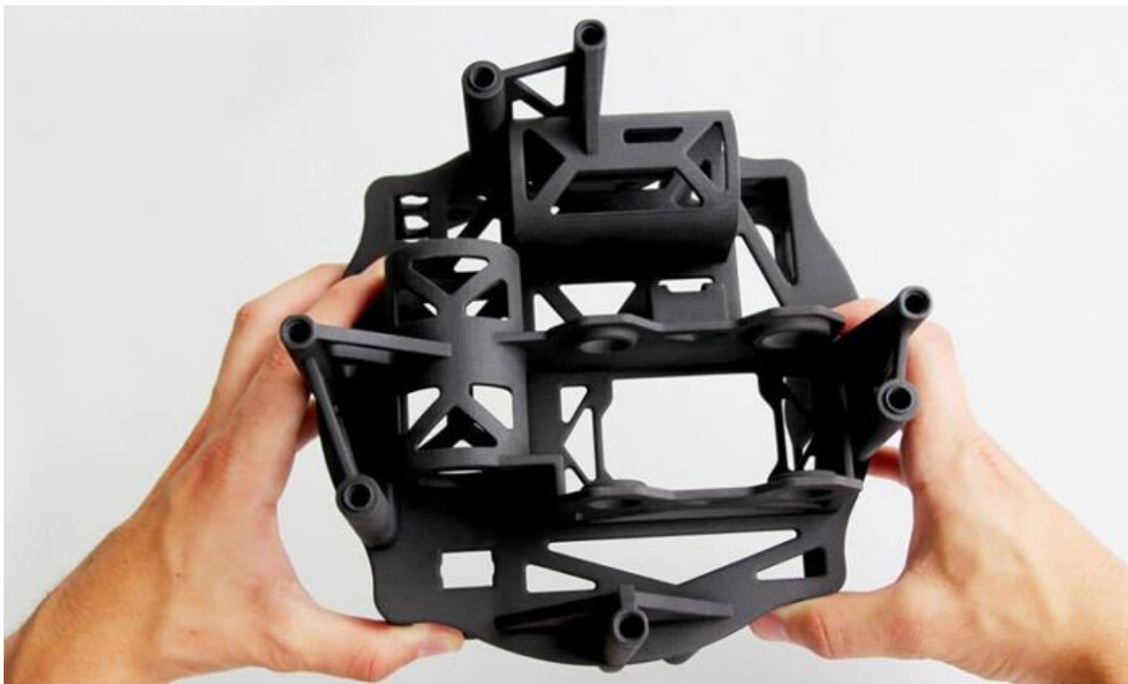
Рисунок 4.9 – Сложная деталь из нейлона
