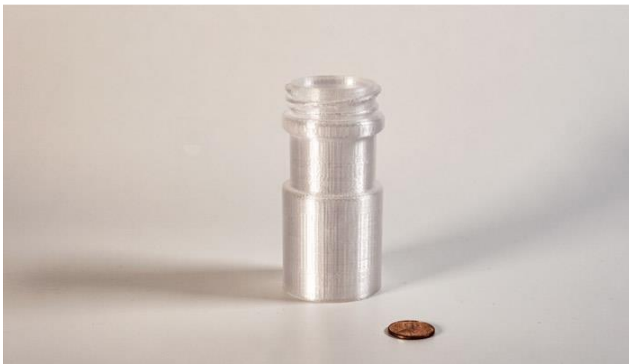
Рисунок 4.6 – Пример печати поликарбонатом
