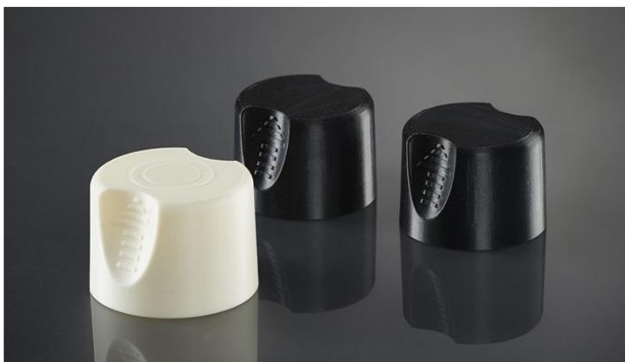
Рисунок 4.3 – Результат печати пластиком ASA
