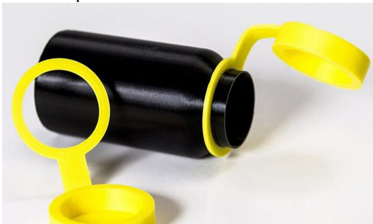
Рисунок 4.8 – Бутылка из полипропилена напечатанная 3д
