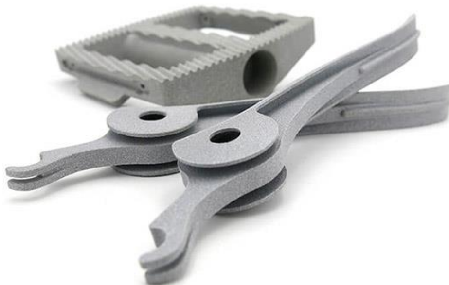
Рисунок 4.12 – Детали напечатанные алюминием
