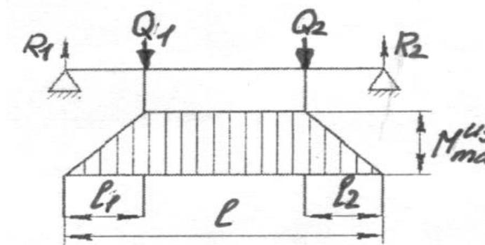
Рисунок 3.9 - Распределенная нагрузка на платформу траверсы
