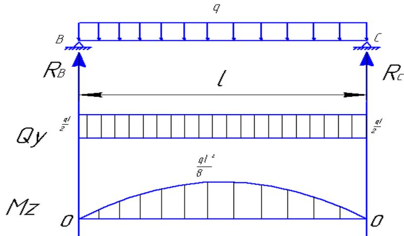
«Рисунок 3.8 - Эпюры для расчета на прочность платформы
