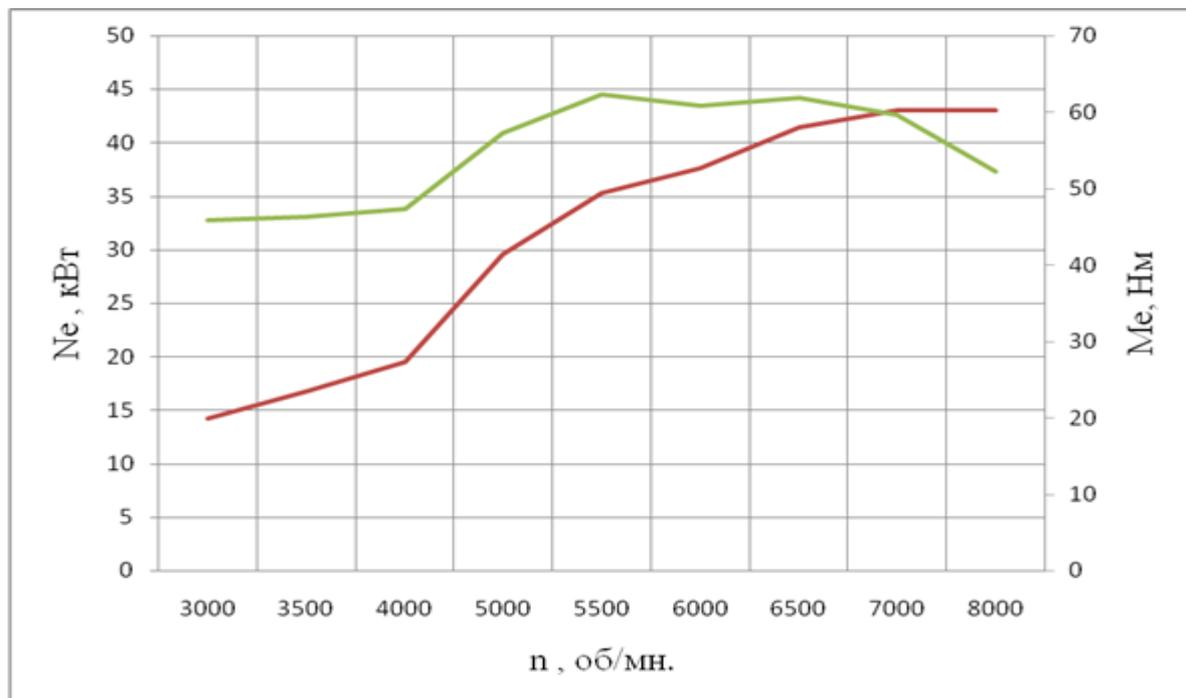
«Рисунок 2.1 – Внешняя скоростная характеристика двигателя автомобиля»
