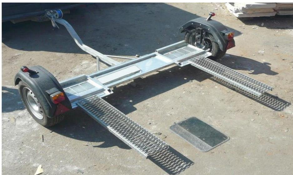
Рисунок 3.2 – Автоприцеп для перевозки автомобилей " Слон-2"
