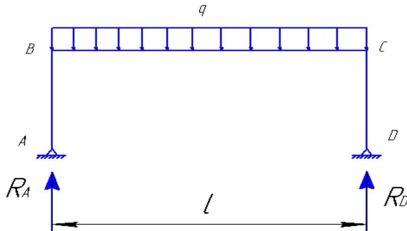
Рисунок 3.7 - Реакция и нагрузка на платформу
