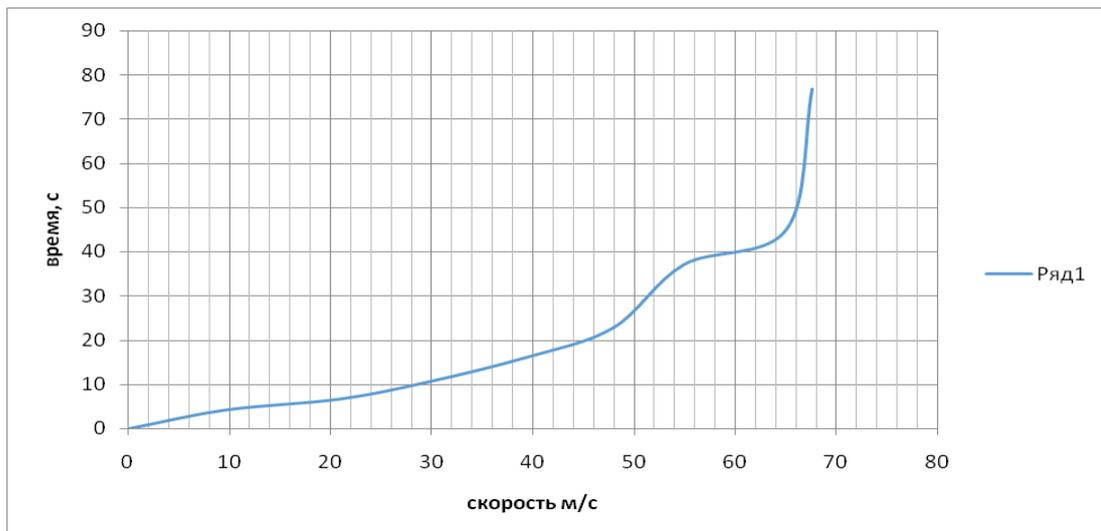
«Рисунок 2.6 – Зависимость времени разгона болида
