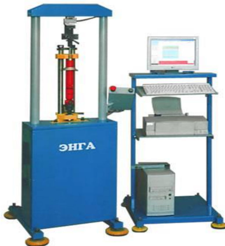
Рисунок. 1.4. - Стенд для испытания амортизаторов
