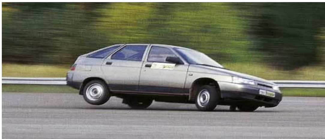
Рисунок 1.5. - При применении стабилизатора заметно больший отрыв
