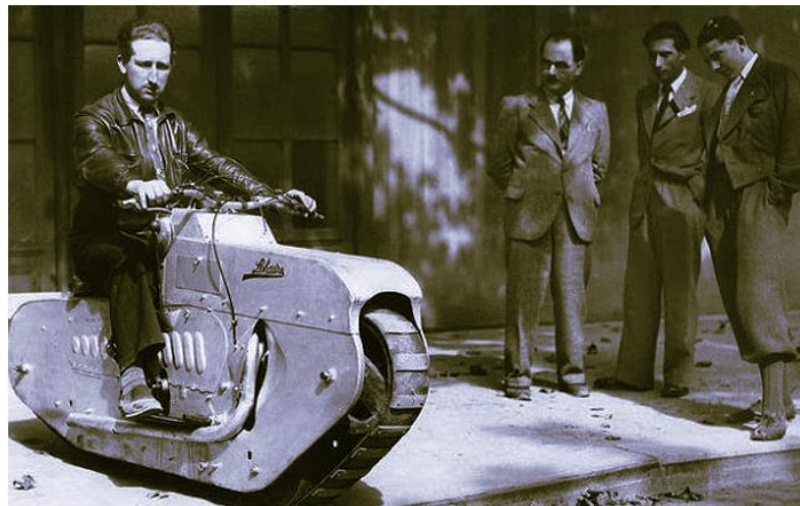
Рисунок 4 – Гусеничный мотоцикл французского конструктора Лээтра (Lehaitre), 1938 г.
