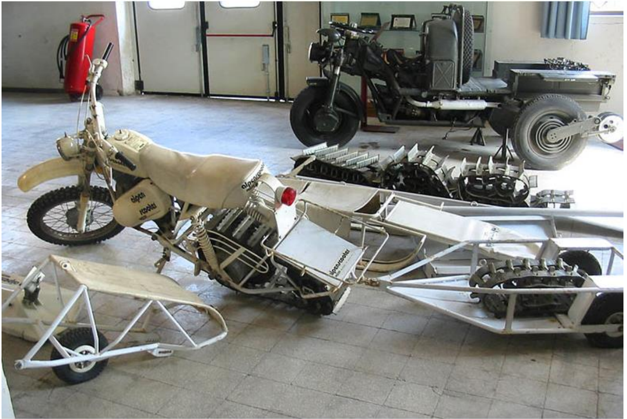
Рисунок 11 – Гусеничный мотоцикл Alpen Scooter компании Pozzo di Resoaro, Италия, 1980-е гг.
